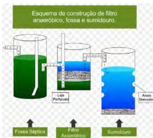
Figura 18 –Ilustração do sistema de tratamento efluente doméstico.
