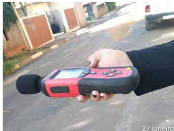
Foto 402 – Equipamento usado para medição de ruído ambiental - decibelímetro. (Data:27/01/2020)
