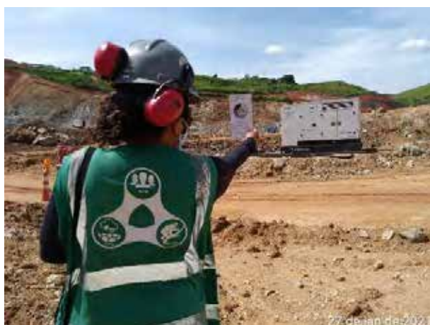
Foto 393 – Monitoramento de fumaça preta em compressor. (Data:27/01/2021)
