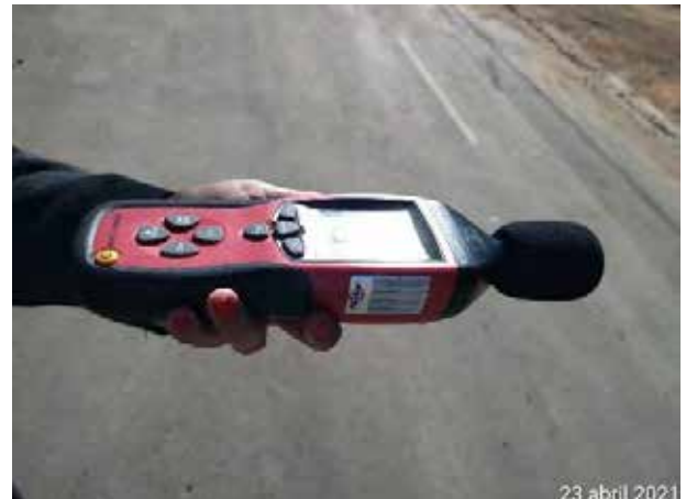
Foto 408 – Decibelímetro - aparelho para monitoramento de ruído ambiental. (Data:23/04/2021)
