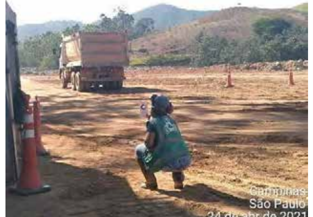
Foto 400 – Medição de fumaça preta em caminhão basculante do Consórcio. (Data:24/04/2021)
