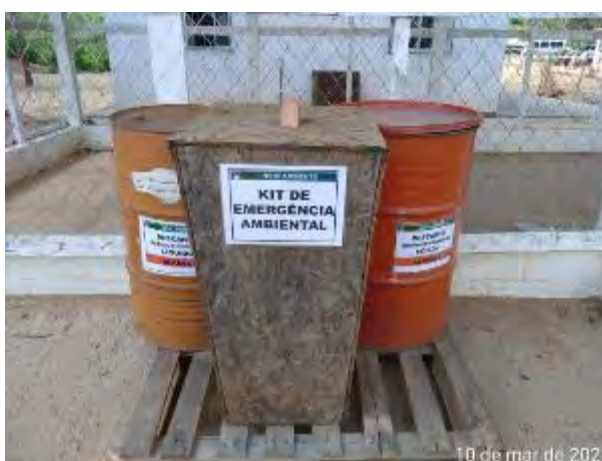
Foto 80 – Kit de emergência ambiental disponível no canteiro operacional. (Data:10/03/2021)
